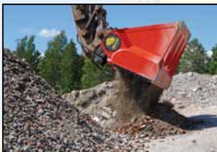
Knusning af tegl og asfalt
