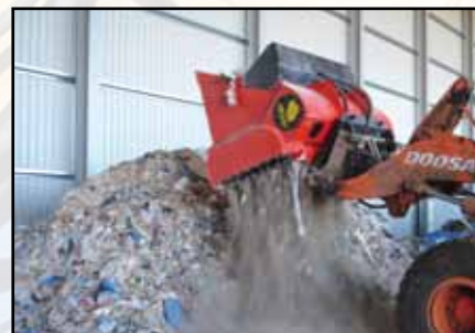
Knusning af nedrivningsaffald
